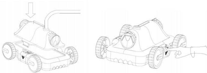
Установите щетку в специальные отверстия на нижней части корпуса очистителя
