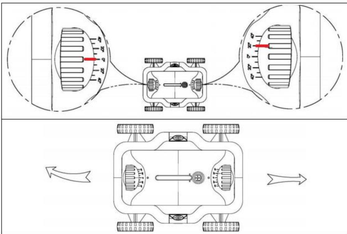
**Вариант 3** Угол 0°/ 40° - для большего покрытия бассейна
