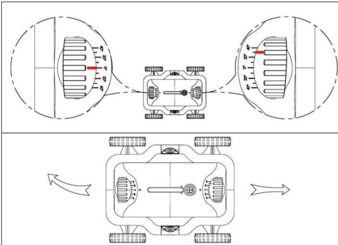
**Вариант 2** Угол 0°/ 20° - выберите этот угол, происходит скручивание кабеля
