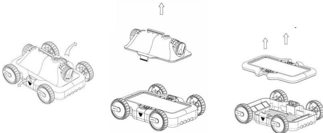
Промойте фильтр и лоток фильтра. Далее установите все элементы в обратном порядке. Закройте защелки.
